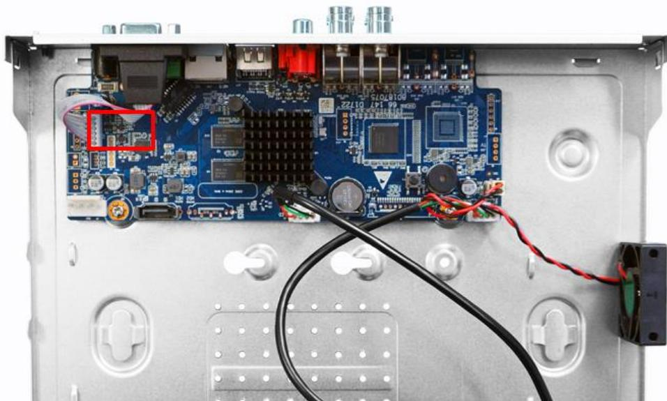
Рисунок 6.124 Возможный пример нахождения кнопки сброса
