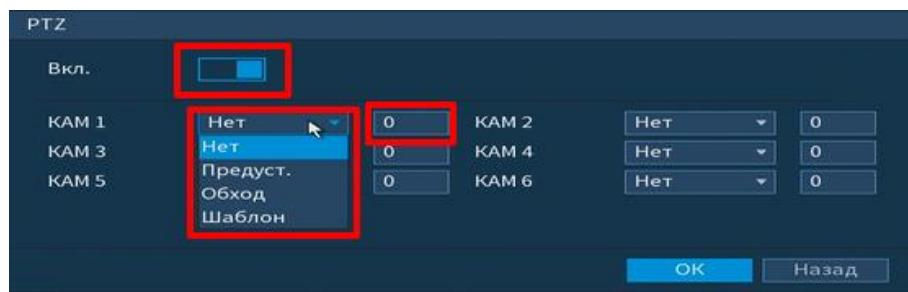
Рисунок 6.28 Настройка предустановки
