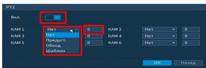
Рисунок 6.50 Настройка предустановки
