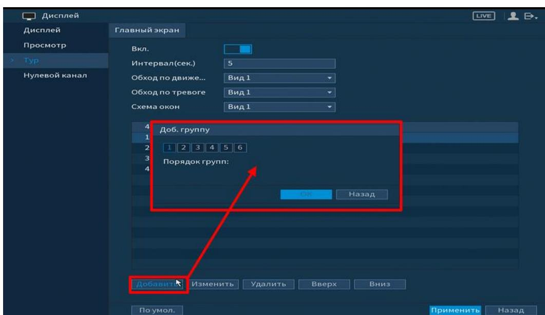
Рисунок 6.68 Установка обхода по камераам
