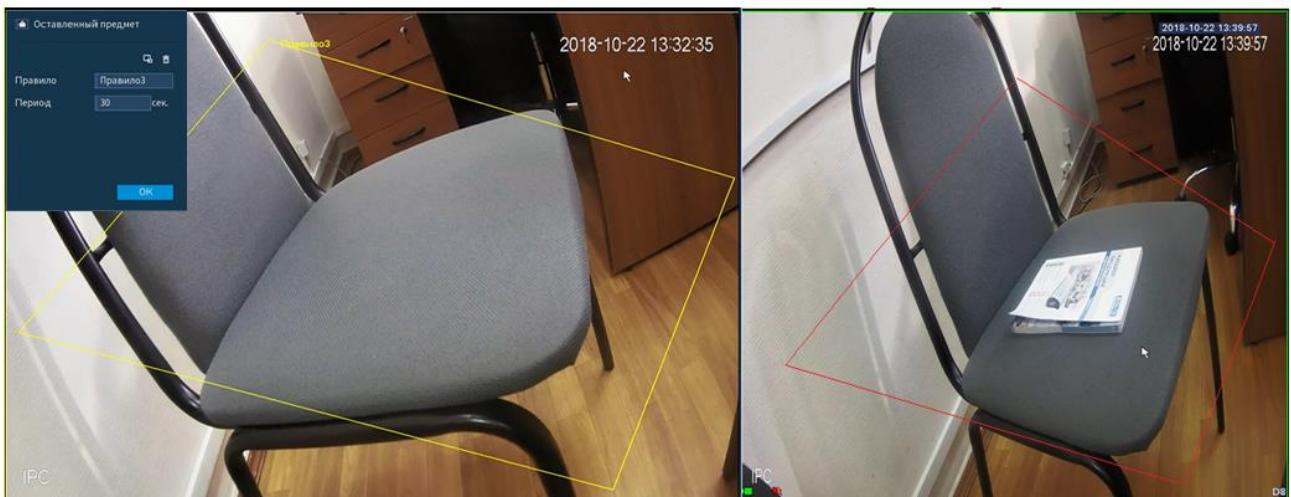
Рисунок 6.47 «Оставленные предметы» до и после срабатывания
