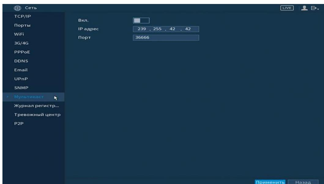
Рисунок 6.94 Интерфейс настройки «Мультикаст»
