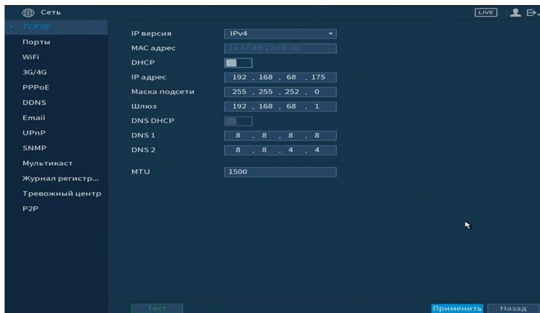
Рисунок 6.87 Интерфейс настройки «TCP/IP»
