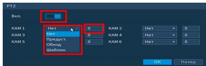
Рисунок 6.31 Настройка предустановки
