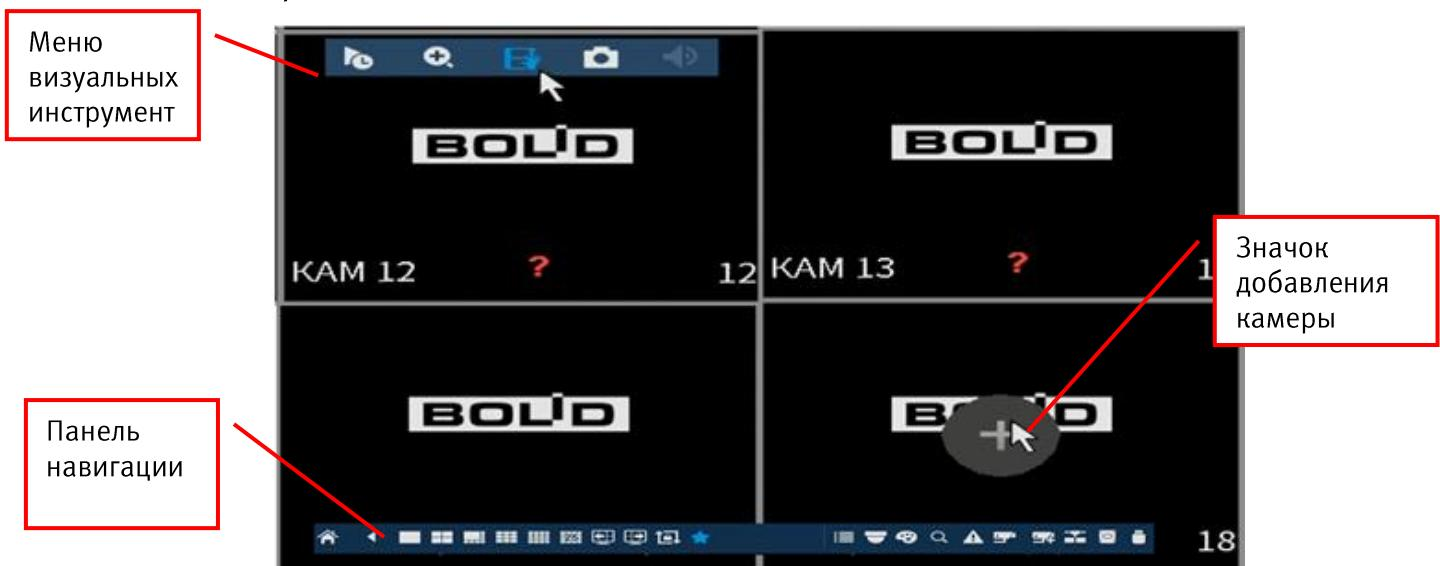
Рисунок 5.10 Добавление IP-камер
