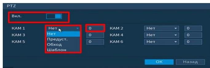
Рисунок 6.62 Настройка предустановки
