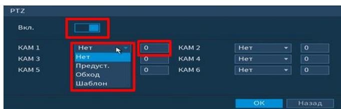
Рисунок 6.19 Настройка предустановки
