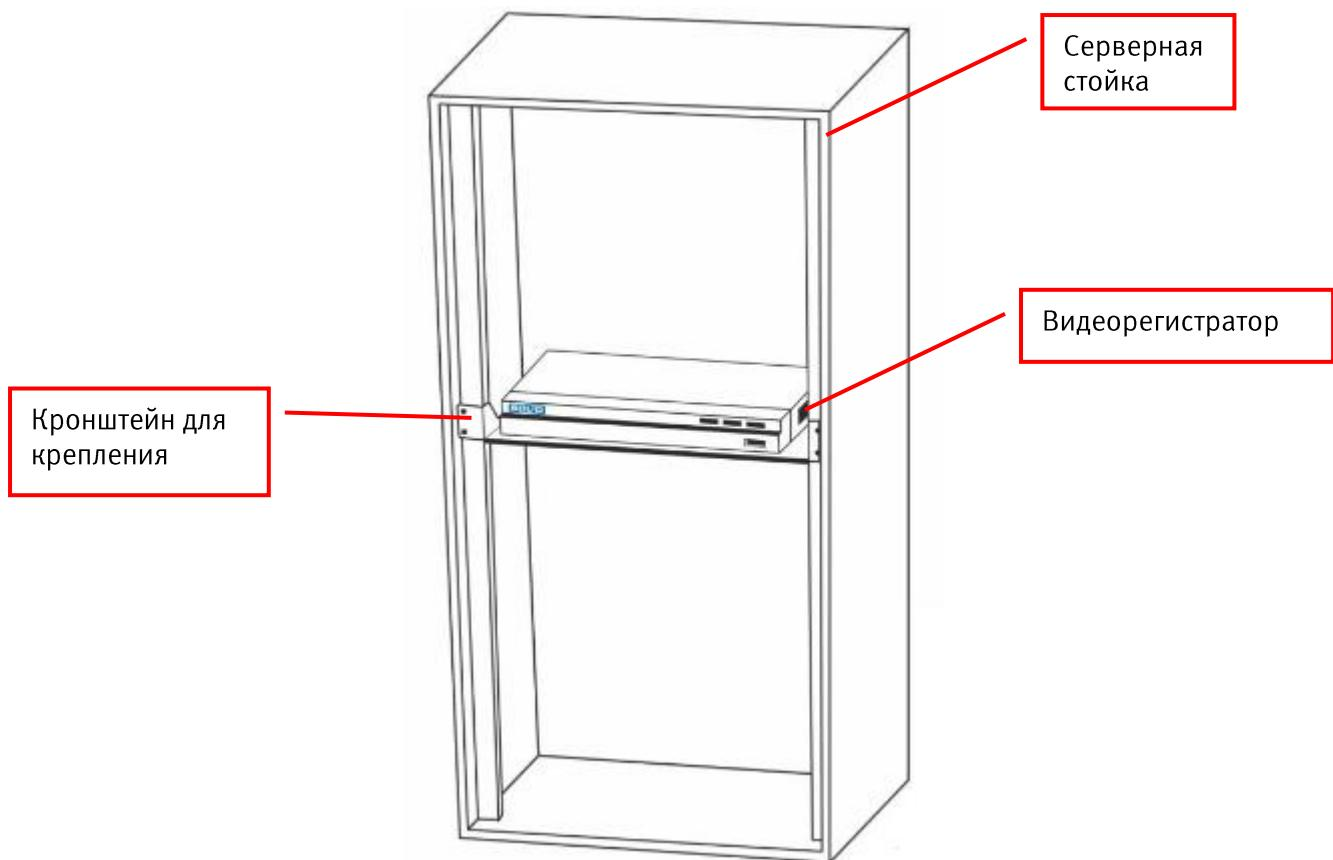
Рисунок 3.12 Монтаж видеорегистратора в 19"- стойку с помощью кронштейна
