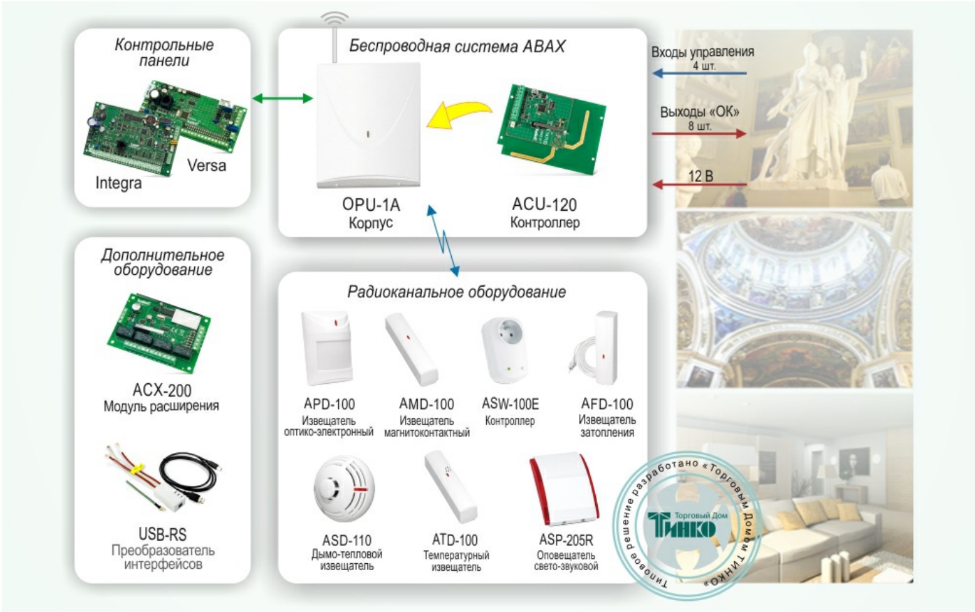
Схема построения системы охранной сигнализации с двухсторонней связью АВАХ
