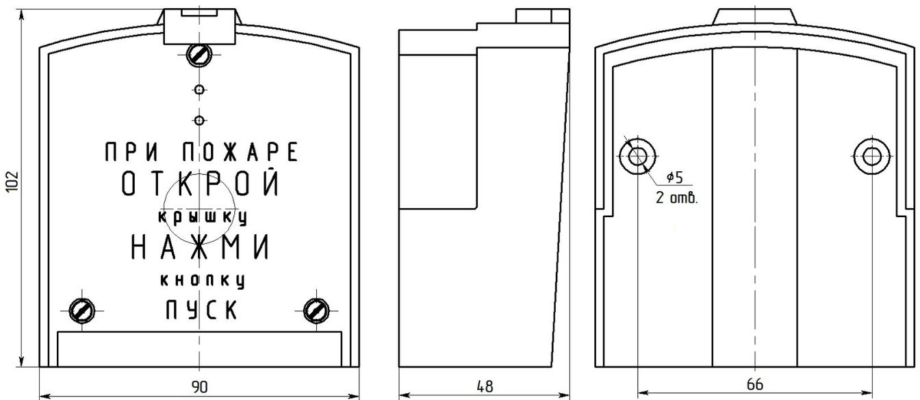
**Устройство сигнально - пусковое автономное автоматическое для установок пожаротушения УСПАА-1** соответствует требованиям ТУ 26.30.50-032-00226827-2017.
