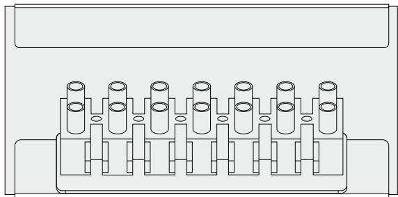
Схема клеммной колодки для модели PT-6K(L) / PT-10K(L)
