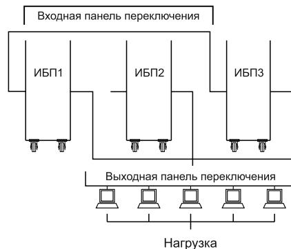
7.3.2 **Запуск:** Приборы переходят в режим «Сеть» (UPS ON) одновременно с последовательным запуском в режиме электропитания;
